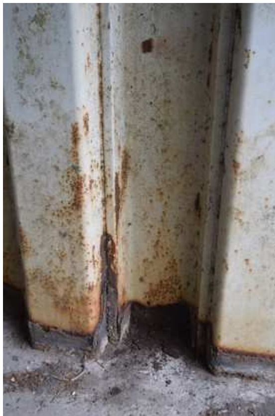
13 – Détail de deux mesures d'épaisseur sur l'âme d'une palplanche, l'une en zone saine, l'autre en zone fortement corrodée
